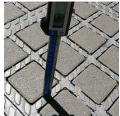
Vorgehen bei der Messung der Noppung.
